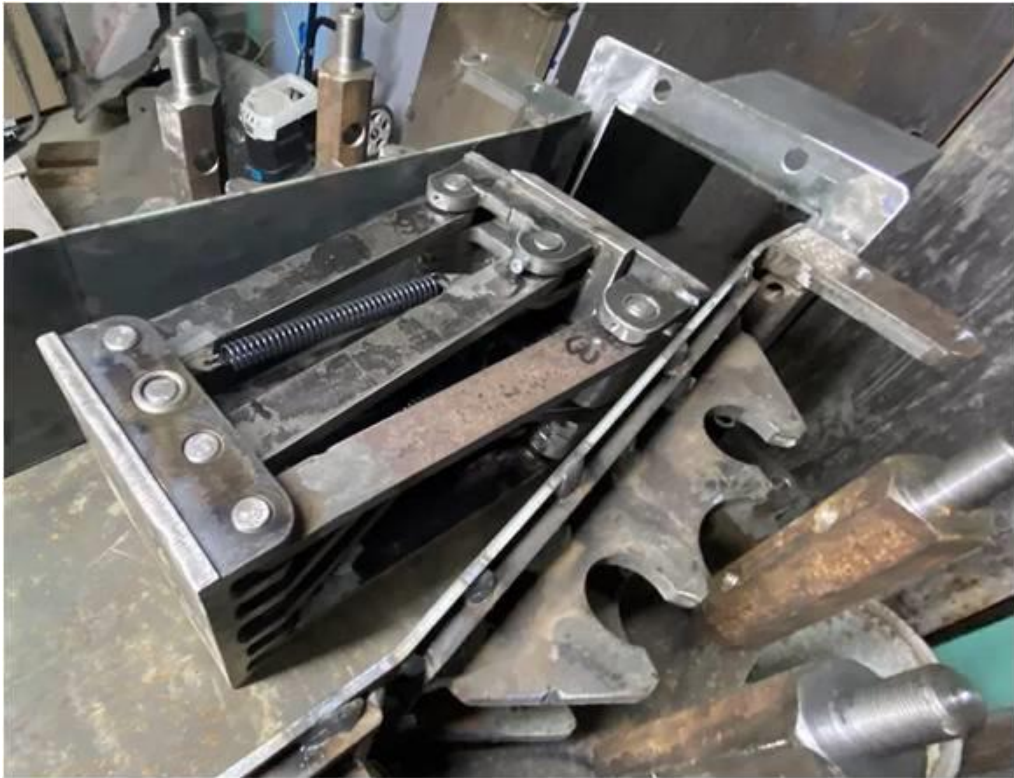
Рисунок 3.2 – Поршень в сужающейся части камеры прессования
