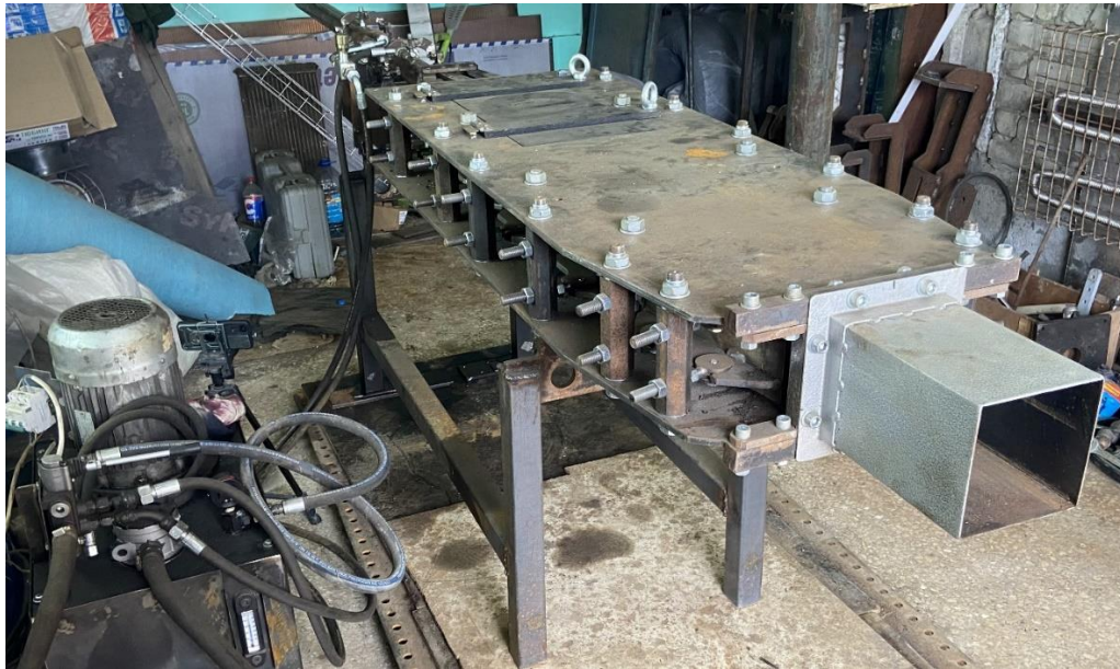
Рисунок. 3.1 – Общий вид пресса для формирования блоков субстрата
