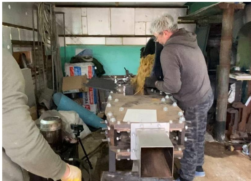
Рисунок 4.15 – Фрагмент исследований гидравлического поршневого пресса с использованием резки соломы
