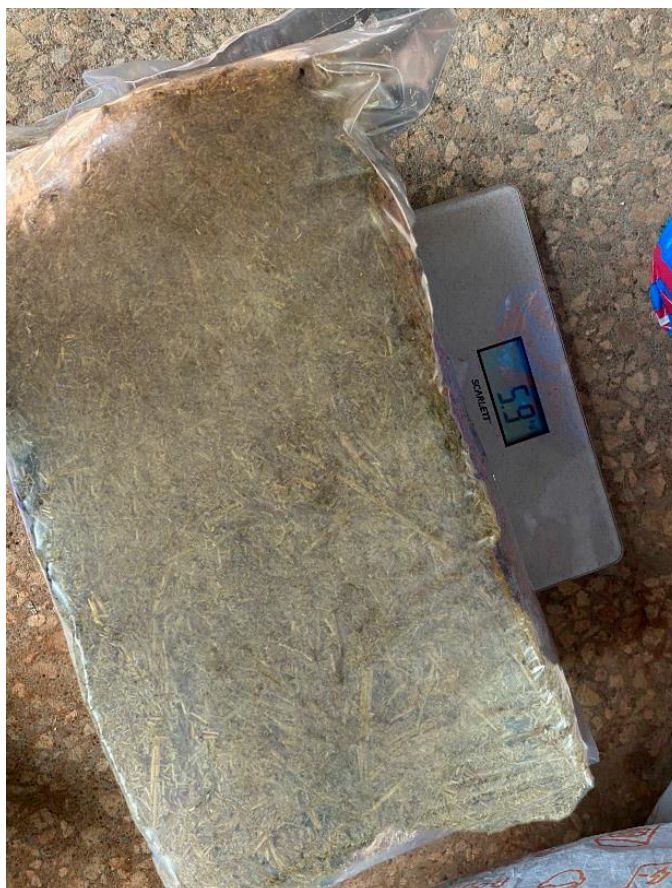
Рисунок 3.9. – Взвешивание готового блока и определение других параметров
