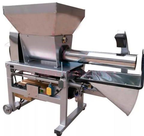
Рисунок 1.8 – Шнековый упаковщик субстратных блоков (Китай, JZSY)
