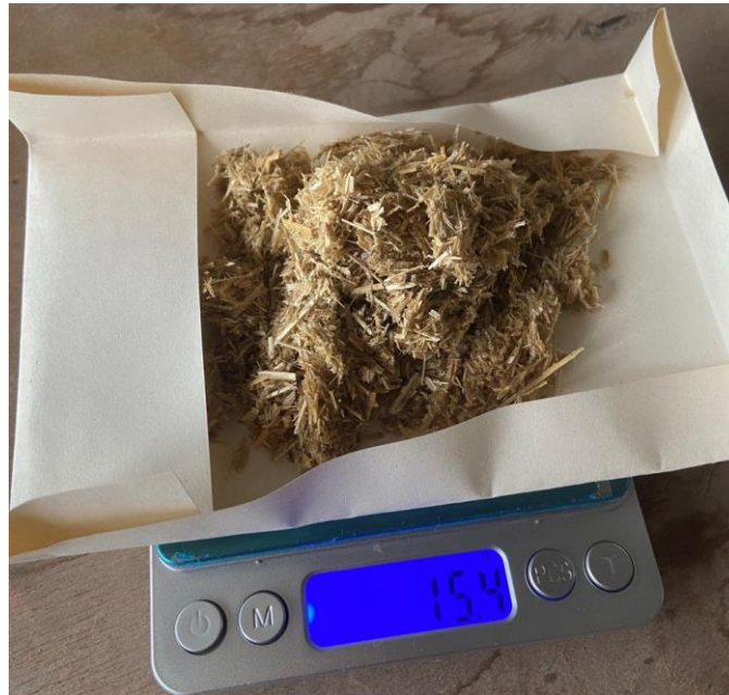
Рисунок 4.3 – Анализ влажности сырья в производственной лаборатории
