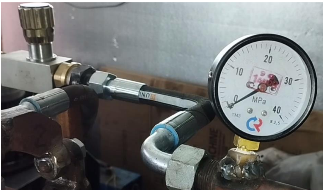
Рисунок 3.8 – Датчики давления масла в гидросистеме
