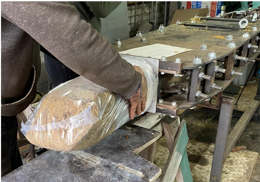
Рисунок 3.7 – Пресс в работе (заполнение пакета субстратом)
