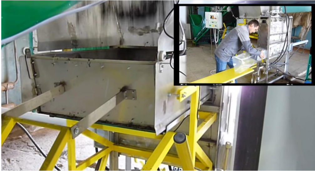
Рисунок 1.3 – Схема существующей технологии создания субстратного блока с помощью гидравлического формовщика блоков
