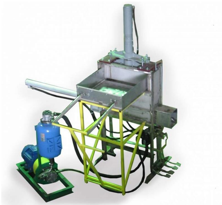
Рисунок 1.5 – Гидравлический пресс субстратных блоков ПМСБ-1Э
