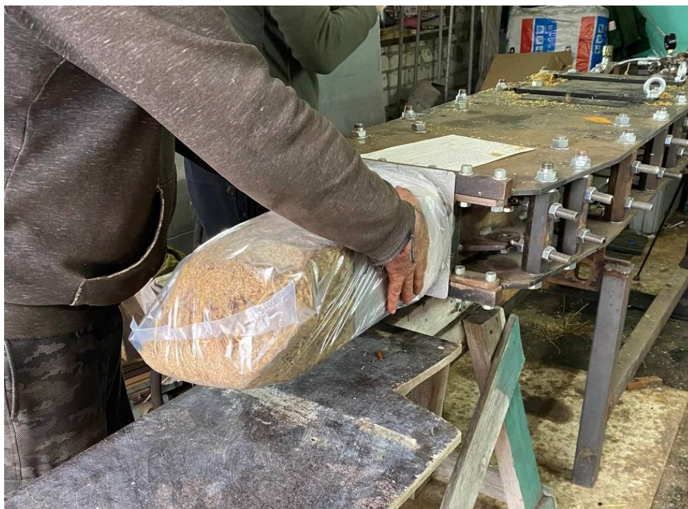
Рисунок 5.1 – Производственные испытания машины для формирования субстратных блоков
