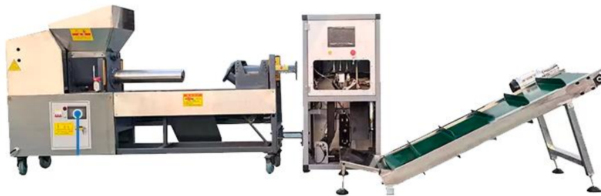
Рисунок 1.3 – Схема существующей технологии создания субстратного блока с помощью гидравлического формовщика блоков
