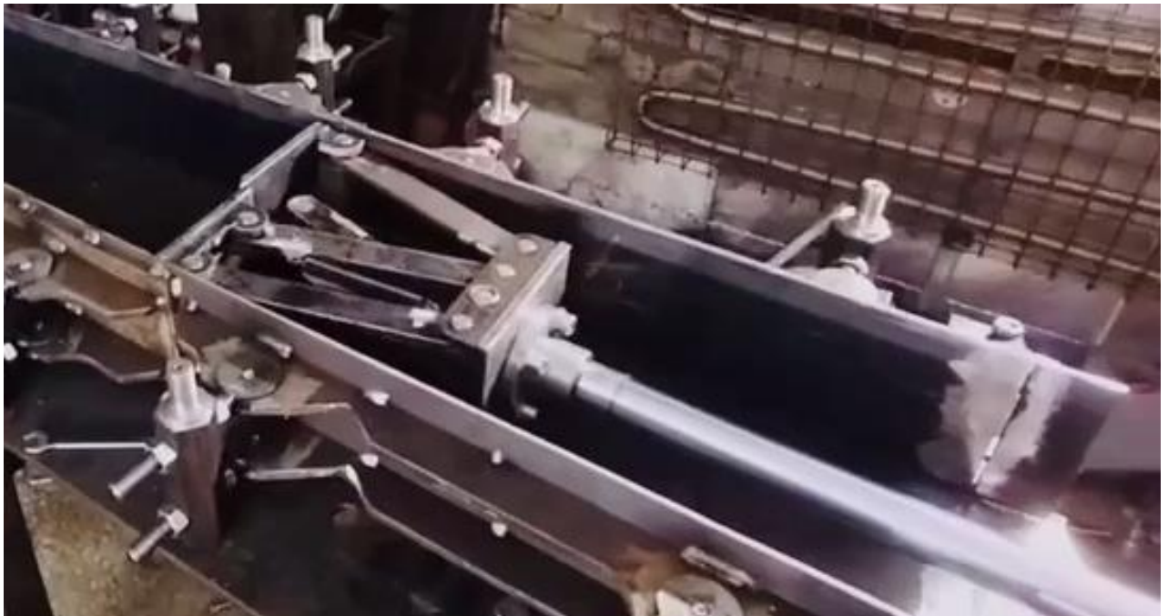
Рисунок 3.3 – Гидроцилиндр для движения поршня
