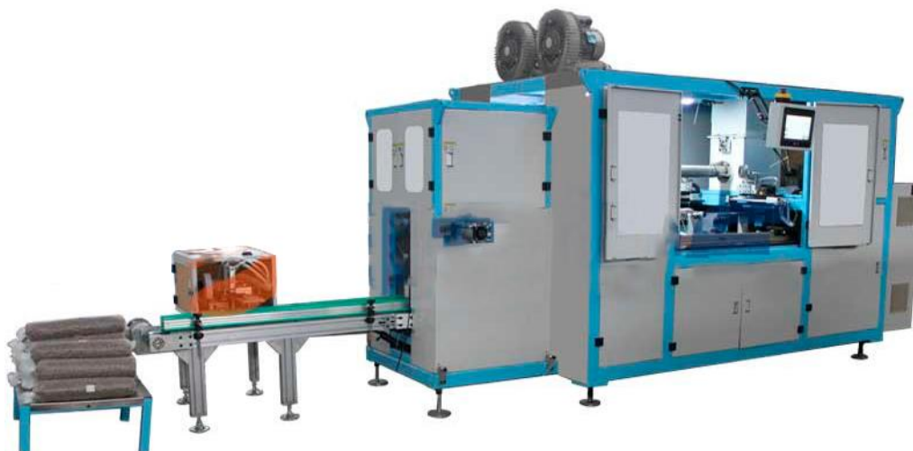
Рисунок 1.9 – Шнековый упаковщик субстратных блоков (Китай, JZSY)
