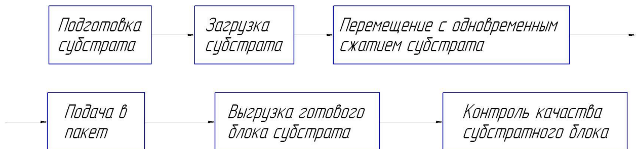
Рисунок 2.1 – Общая технологическая схема формирования блока грибного субстрата
